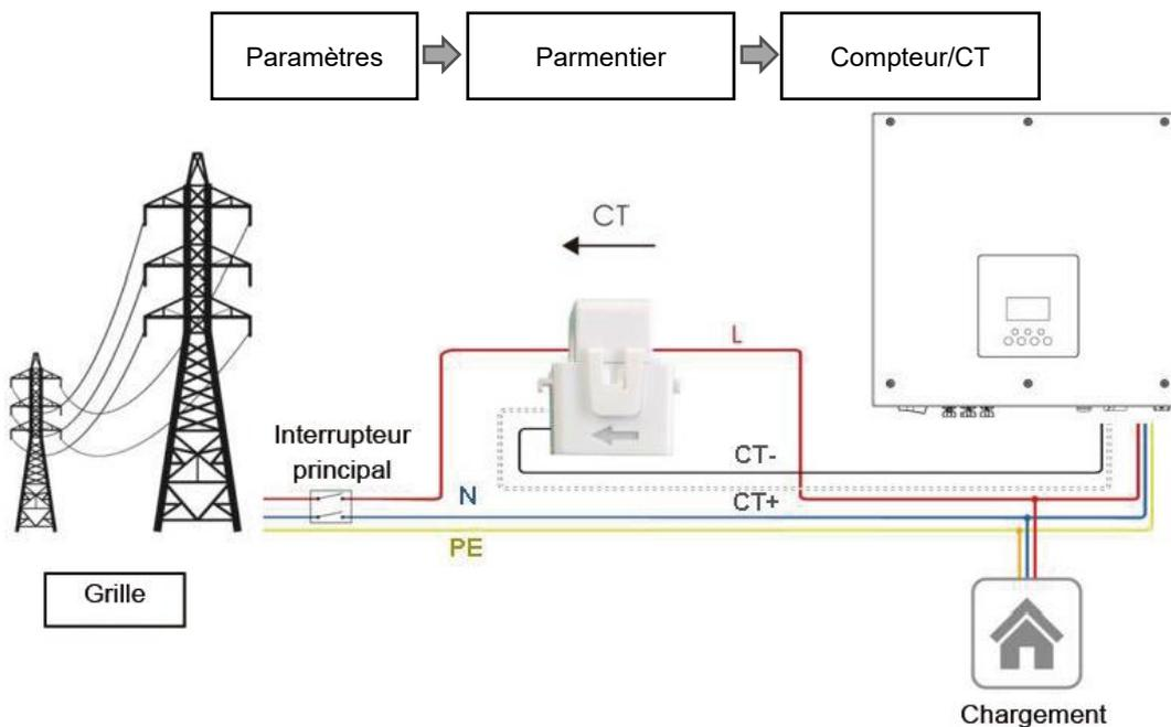
S'il y a un autre générateur dans la maison, le CT2 peut être utilisé pour enregistrer la puissance générée par le générateur et transmettre les données au site Web pour le suivi.
