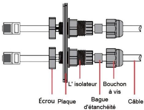
Étape 3: Insérez le connecteur du câble dans le port DRM/COM situé au bas de l'onduleur et vissez-le fermement. Insérez ensuite l'autre côté du câble réseau dans le PC ou un autre appareil.
