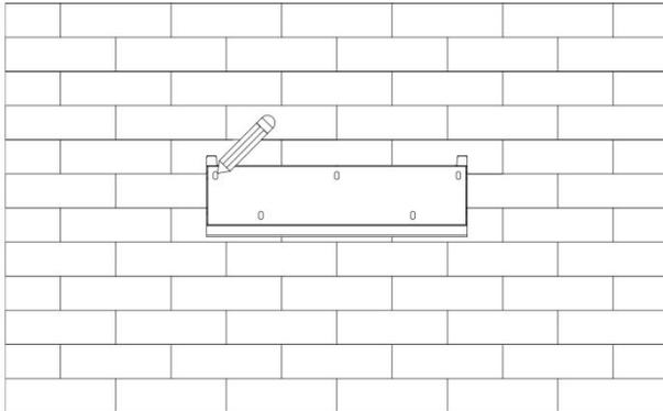
Percez des trous avec une perceuse électrique, assurez-vous que les trous ont une profondeur d'au moins 50 mm, puis serrez les tubes d'expansion.
