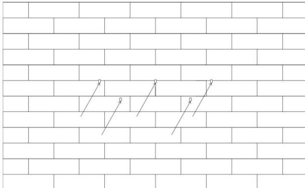
Insérez les tubes d'expansion dans les trous et serrez-les. Installez le support avec les vis d'expansion.
