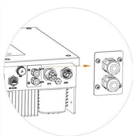
Étape 2: Préparez un câble réseau standard et un connecteur de câble, puis insérez le câble réseau dans le connecteur de câble.
